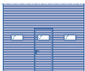
Секционные ворота APU F42 с калиткой без порога
